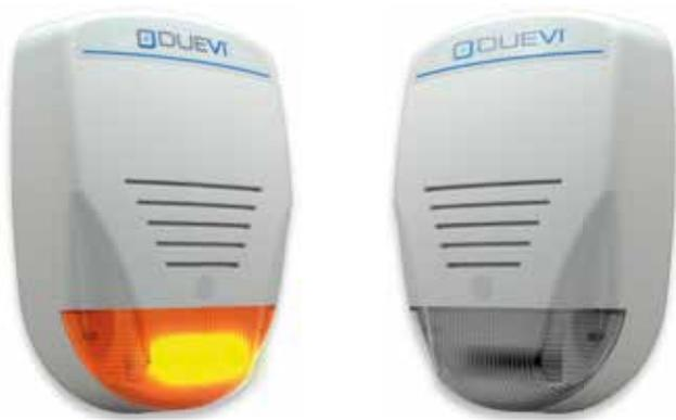
Sirena da esterno con tromba magnetodinamica e flash led alta luminosità. Protezione tamper antiapertura/antiasportazione. Schermo metallico interno antisciuma. Contenitore in ABS e policarbonato bianco. Dimensioni circa 310x210x85mm.
