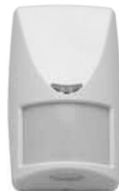
Tecnologia IR passivo via radio supervisionato. Regolazione della sensibilità e conteggio impulsi. Portata circa 10 metri. Apertura fascio circa 105°. Alimentazione a batteria alcalina 9V mod. BAT9 (non inclusa). Autonomia circa 2 anni con 10 allarmi/giorno + supervisione. Snodo non incluso.
