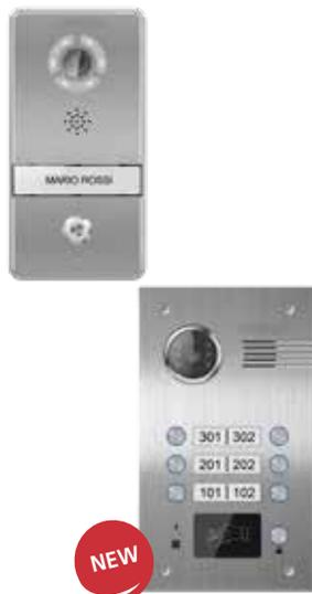
Posto esterno videocitfonico IP per la gestione delle chiamate videocitfoniche direttamente da una o più tastiere Simplya Video III (vers. FW compatibile). Telecamera da 1 Mpx con led per visione notturna, utilizzabile anche per funzioni di Videosorveglianza. Pulsante apriporta (magnetica/elettrica). Lettore card reader per apertura porta. Alimentazione a 12V e POE. In acciaio (IP55).
