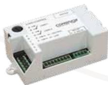
Modulo domotico su BUS RS485, in cassetta 504, per la gestione di tipo ON/OFF di **due carichi domestici** con tensione fino a 250 Vac/250 Vdc e corrente 10A. Compatibile con centrali linea Amica (64/128/324), dotate di almeno una tastiera touch screen Simplya.
